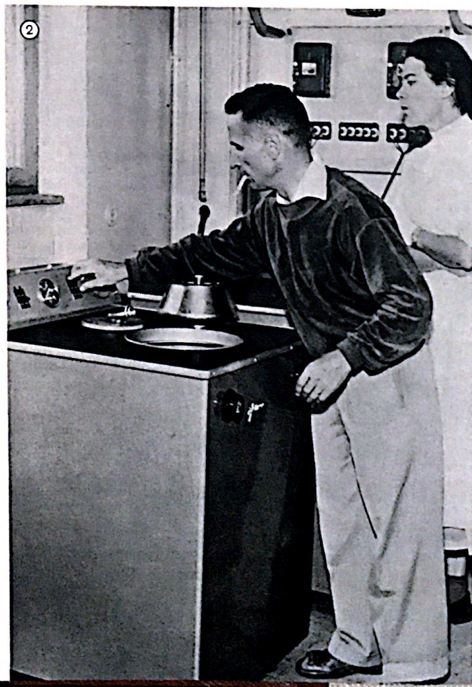
2. Un'ultracentrifuga che serve per la preparazione del DNA.
