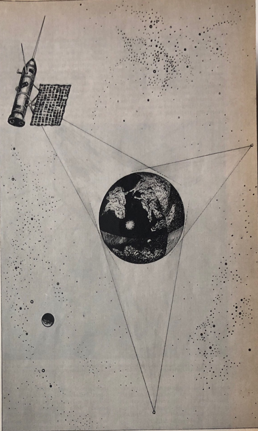
▲ Un sistema di tre satelliti, spazati di 120^\circ tra loro e ruotanti all'altezza di circa 36 mila chilometri lungo un'orbita equatoriale, sarebbe sufficiente per creare una completa rete spaziale di comunicazioni. Nello schema sono chiaramente visibili le zone di sovrapposizione (da Industrial Research ).
