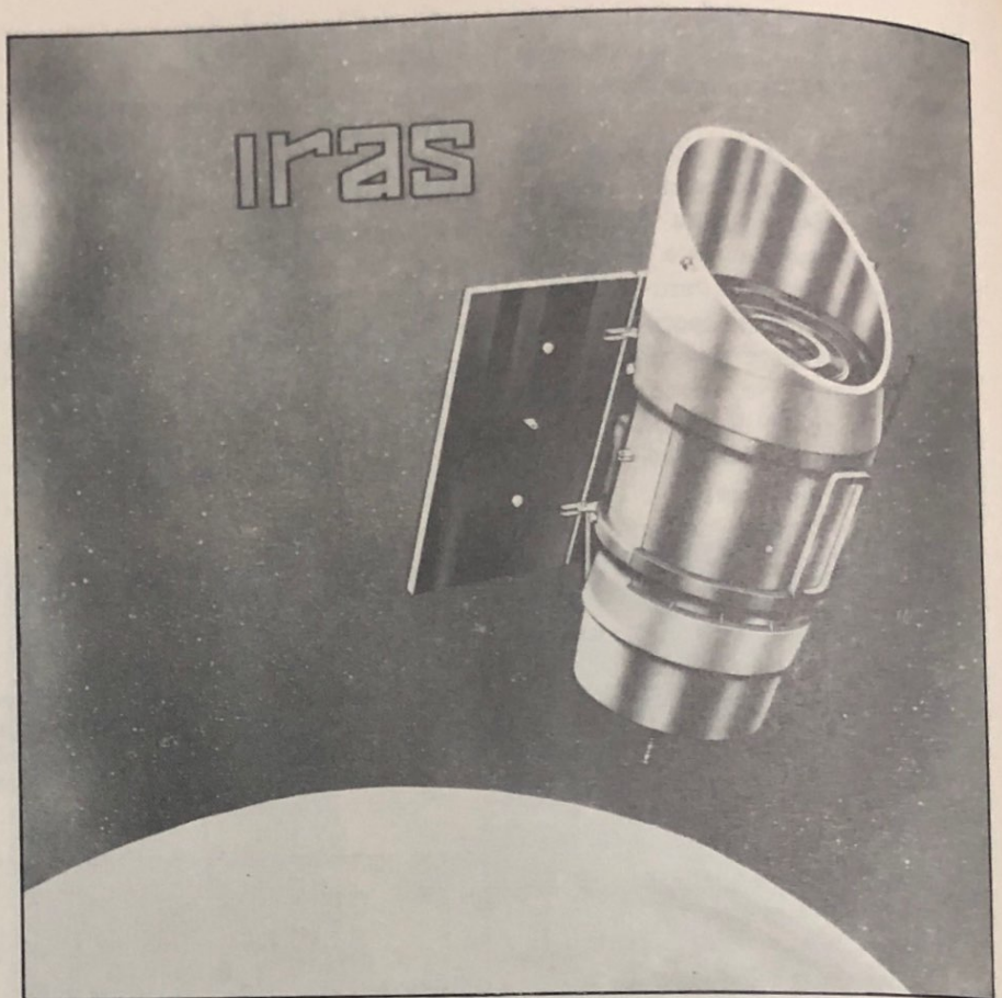
Fig. 3 Immagine del satellite infrarosso IRAS: il satellite è letteralmente costruito intorno al telescopio raffreddato all'elio liquido. (per cortese concessione della NASA, Goddard)
